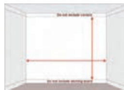
۱- اندازه‌گیری محدوده دیوار برای رنگ‌آمیزی شکل ۲۰-۵
